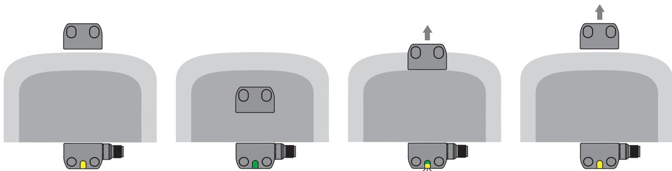
Il sensore è alimentato, gli ingressi sono abilitati, le uscite sono disabilitate. L'azionatore è all'esterno della zona di azionamento. Il LED è acceso con colore giallo fisso.
