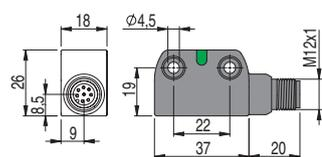
Sensore ST H••••M• con connettore M12
