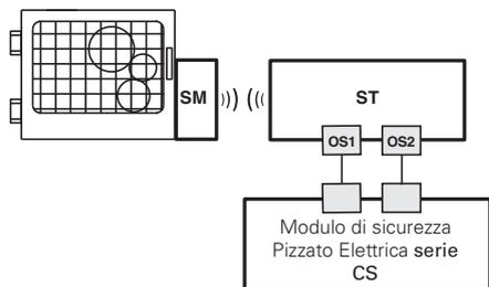
Il sensore ST può essere usato singolarmente previa valutazione delle uscite da parte di un modulo di sicurezza Pizzato Elettrica (vedi tabella moduli di sicurezza abbinabili).
