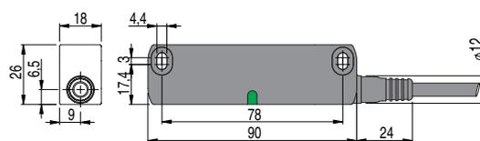
Sensore ST G••••M• con connettore M12
