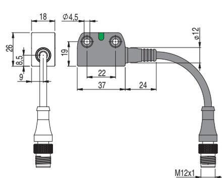
Sensore ST H••••M0.2 con cavo e connettore M12
