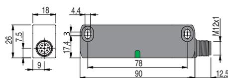
Sensore ST G••••M0.2 con cavo e connettore M12
