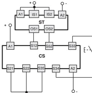
Collegamenti con i moduli di sicurezza CS AT-0●●●●● / CS AT-1●●●●●
